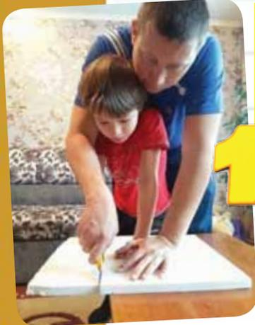
**1) Из пенопласта делаем боковые стороны, дно и крышку инкубатора, склеиваем их между собой и закрепляем саморезами.**
