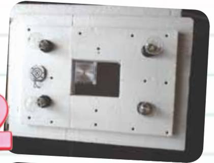
**2) Теперь работа для пап! А вы смотрите и запоминайте. В крышке инкубатора вырезаем отверстие для смотрового окошка, крепим стекло и наклеиваем на него термометр, устанавливаем транзистор, вкручиваем в патроны лампочки.**
